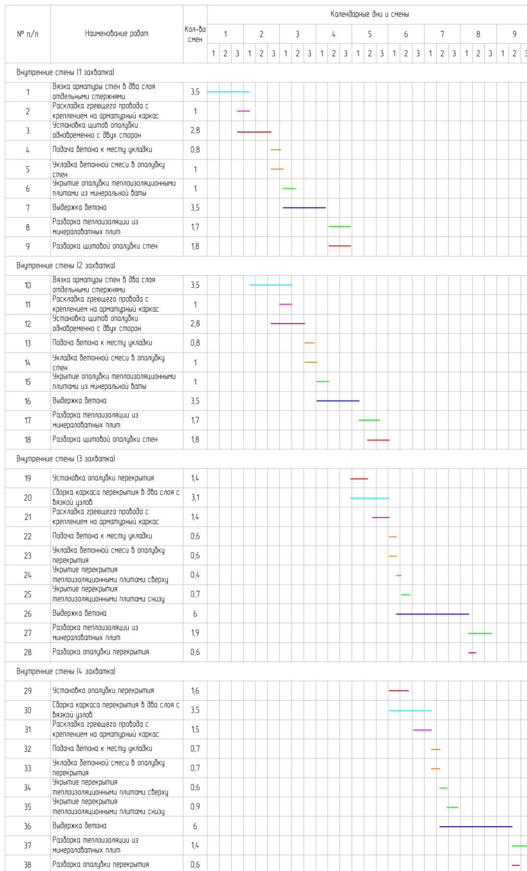
Рис.4 График производства работ по возведению монолитных конструкций на типовом этаже (продолжение)
